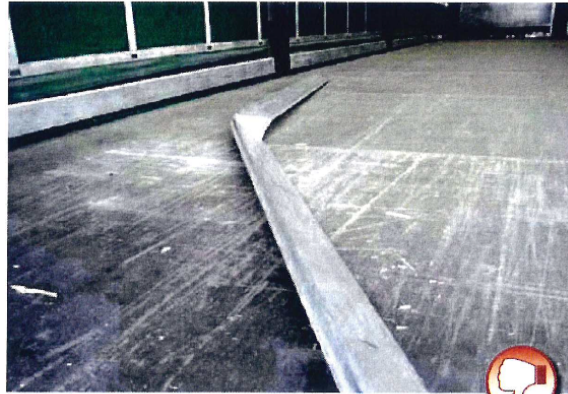
Alu-drop-in slats Bent drop-in slats
